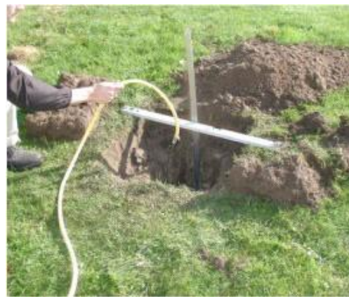
Vandmætning af jorden kan begynde. Der fyldes min. 20 cm vand over gruslaget.
