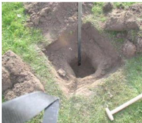
Der hældes ca. 5 cm grus i bunden af prøvehullet.
